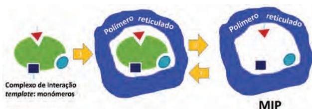
**Figura 1** – Esquema simplificado do processo de impressão molecular: 1) Polimerização reticulada na presença do *template*; 2) extração do *template* no final da reação deixando o sítio ativo disponível; 3) na aplicação final os sítios ativos voltam a ligar-se à molécula de *template*
