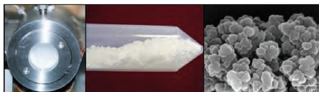
**Figura 2** – a) Reação de polimerização a decorrer numa célula de alta pressão; b) Aparência de um MIP; c) Imagem SEM
