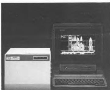
O Diode Array L-4500, abre uma nova dimensão na análise por HPLC. É o primeiro detector a utilizar um prisma para a dispersão da luz, o que se traduz na mais elevada resolução espectral, permitindo obter um ótimo espectro mesmo a valores de absorção na ordem de  $10^{-3}$  unidades.
