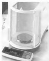
Nova Balança microanalítica, modelo HA-202M, capacidade 42/210 g, resolução 0.01/01 mg.
