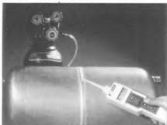
O detector de fugas GAS CHECK de ION SCIENCE (Cambridge, Inglaterra) é um equipamento portátil (50x60x365 mm), com microprocessador incorporado, que permite a detecção automática de fugas de gases, sempre que estes sejam de composição distinta à da atmosfera na zona a analisar.
