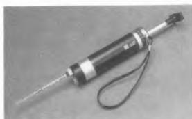
Os sistemas de Detecção da *Gastec* permitem detectar vários gases (CO, CO<sub>2</sub>, SO<sub>2</sub>, H<sub>2</sub>S, Cl<sub>2</sub>, etc.) e medir a sua concentração.
