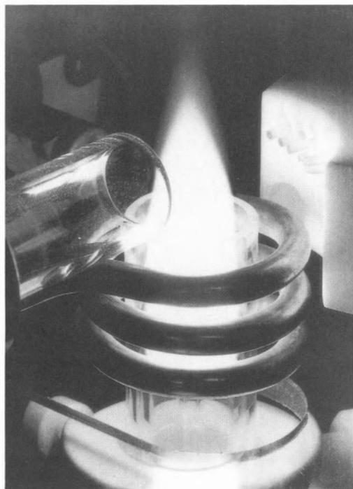
Espectrómetros de emissão óptica por fonte de plasma (ICP) de elevadas performances analíticas, para análises simultâneas ou sequenciais de elementos em solução.
